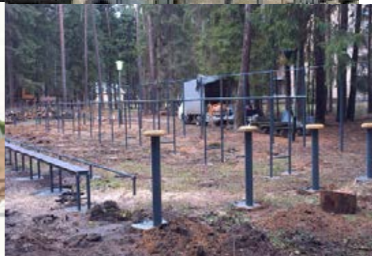
Арт 4247 Спортивный городок для армейского подразделения Включает : линию многопролетных перекладин, линию брусьев, «грибки» для прыжков, гимнастические скамейки с упорами для ног. Габариты: 25x15 м
